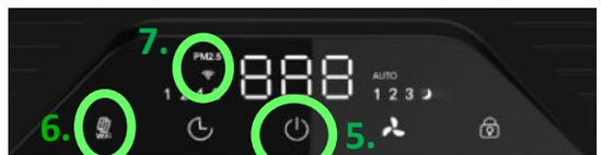
Die WIFI-Taste (6.) ist im ausgeschalteten Zustand nicht sichtbar! Finger auf diese Position legen.
