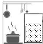
8. Verwenden Sie das Gerät nicht in der Nähe von Gasgeräten, Heizgeräten, Heizlüftern oder Öfen. Zu warme Umgebungsluft schädigt die Filter und verursacht im Extremfall dauerhaften Schaden am Gerät.
